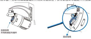
5. 摘下挂扣在上球罩螺钉上的安全挂钩,盖扣上球罩并拧紧上球罩上两颗固定螺钉。
