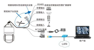
【说明】具体线缆连接以实际设备上所贴线缆标签为准。
